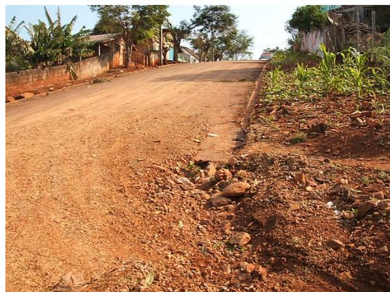
Figura 69: Inexistência de passeio, meio-fio e sistema de drenagem pluvial
